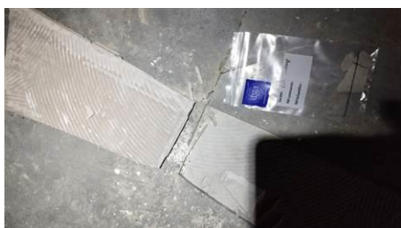
Matériaux : ZPSO-026 Prélèvement : P032 Description : Colle de carrelage Localisation : Rez de chaussée - salle de restaurant 1 Résultat : Absence d'amiante
