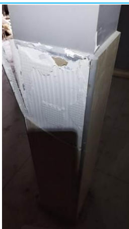
Matériaux : ZPSO-022 Prélèvement : P028 Description : Colle de faïence Localisation : Rez de chaussée - salle restaurant 2 Résultat : Absence d'amiante
