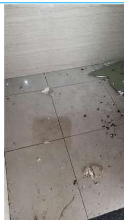
Matériaux : ZPSO-029 Prélèvement : P035 Description : Colle de carrelage Localisation : Rez de chaussée - sanitaires Résultat : Absence d'amiante
