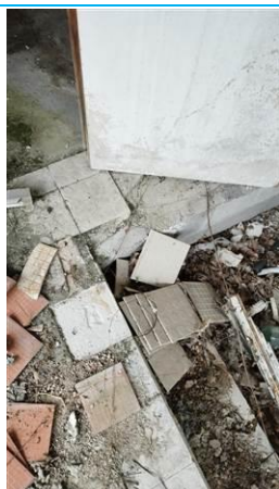
Matériaux : ZPSO-003 Prélèvement : P008 Description : Colle de carrelage Localisation : Rez de chaussée - terrasse arrière Résultat : Absence d'amiante
