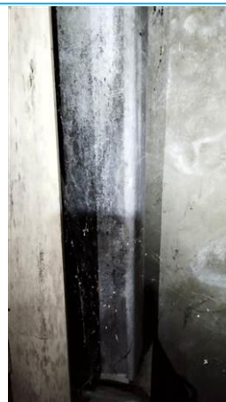
Matériaux : ZPSO-049 Prélèvement : P055 Description : Conduit en fibres-ciment Localisation : Sous-Sol - cave 1 Résultat : Présence d'amiante
