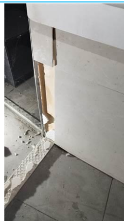
Matériaux : ZPSO-031 Prélèvement : P037 Description : Colle de faïence comptoir Localisation : Rez de chaussée - entrée Résultat : Absence d'amiante
