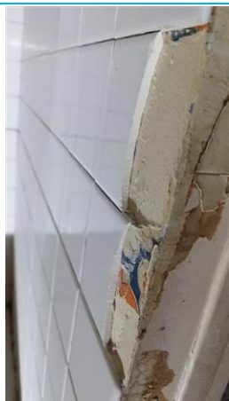
Matériaux : ZPSO-006 Prélèvement : P012 Description : Colle de faïence Localisation : 1er étage - sdb 1 Résultat : Absence d'amiante
