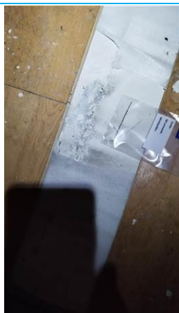
Matériaux : ZPSO-008 Prélèvement : P014 Description : Ragréage Localisation : 1er étage - piece 4 Résultat : Absence d'amiante
