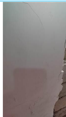
Matériaux : ZPSO-004 Prélèvement : P007 Description : Crépis extérieur Localisation : Rez de chaussée - facade arrière Résultat : Absence d'amiante
